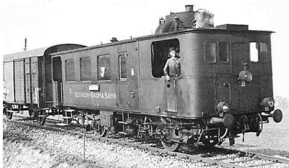
Der Dampftriebwagen CZm 1/2 Nr. 31 «Glettiise» mit stehendem Dampfkessel. Maschinenfabrik Esslingen (Deutschland), 1902
