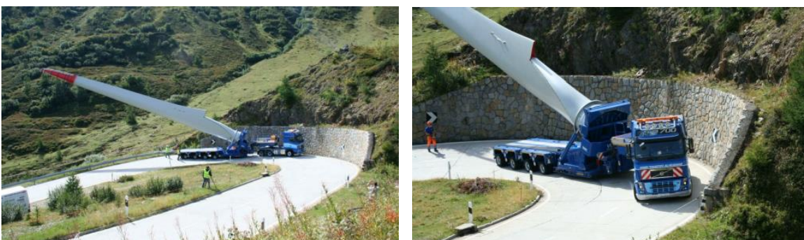
Abbildung 8: Spezialtransport für eine Windenergieanlage am Griespass (CH).
