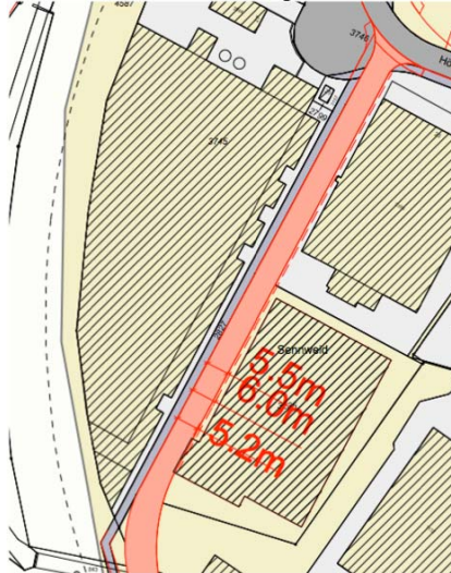
Strasse im Bereich Tafletenweg mit bestehendem Fussweg
